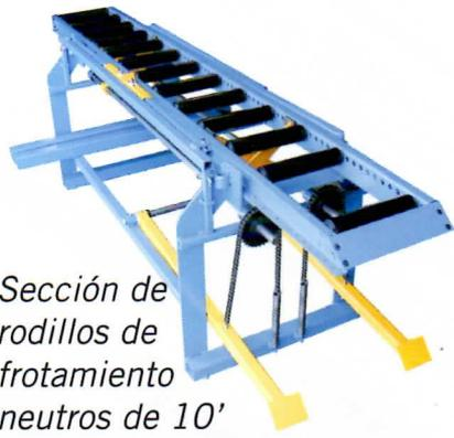
Sección de rodillos de frotamiento neutros de 10' con culateador
