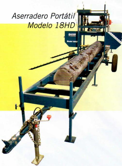
Para aquellos con presupuestos limitados, Baker ofrece los Aserraderos Portátiles Modelos 18M y Modelo 18HD. El cabezal de corte de los modelos 18HD es igual al cabezal de corte del modelo 18M, pero las bancadas difieren. El Modelo 18HD tiene un armazón más pesado para trabajo arduo incluyendo robustas patas de caída tubulares de acero.
