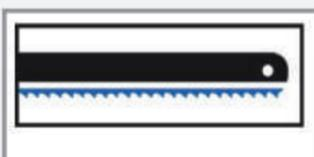
Construcción Bi metálica: Respaldo flexible de acero para muelles y Nuevo filo de acero de Alta Velocidad
