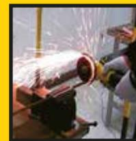
**1** Corte de barras de refuerzo, esmerilado de líneas de soldadura. Esmeril Angular STGS7115 STGS8115
