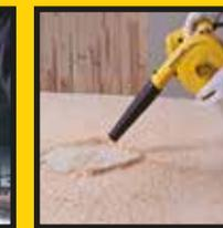
**5** Aspirado de residuos de polvo o bitura de madera. Aspiradora/Soplador STPT600
