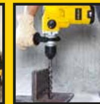
**4** Perforación de agujeros en concreto para colocación de barras de refuerzo. Rotomartillo SDS Plus STRH1232K
