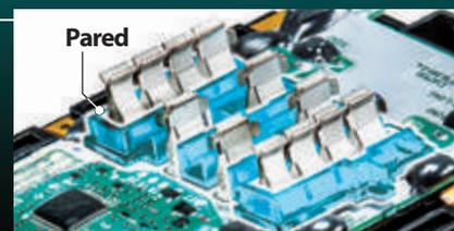
**Estructura de prevención de cortocircuito en terminales.**
