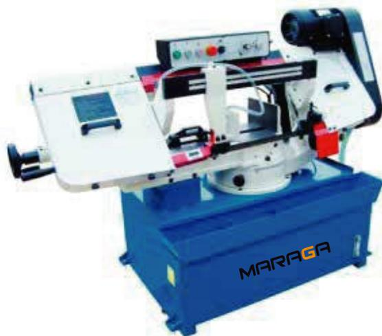
Cabezal giratorio para cortes Angulares
