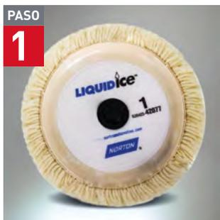
100% lana de carnero. Mayor productividad y alta resistencia. Utilizada para remover las marcas del lijado. Aplicar con presión media entre 1000 y 1200 RPM.
