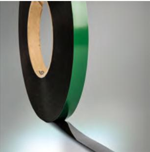
Cinta de alta densidad recubierta con adhesivo acrílico de alta resistencia en ambas caras con revestimiento de polietileno verde. Está diseñado para la unión de pequeñas molduras y accesorios, proporciona una adhesión superior a los plásticos, metal, vidrio y superficies pintadas de vehículos. Especial para emblemas.
