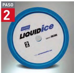
Mayor flexibilidad y durabilidad. Mejor acabado. Utilizada para remover las marcas circulares dejadas por el bonete de lana. Aplicar a una velocidad de 1500 RPM.
